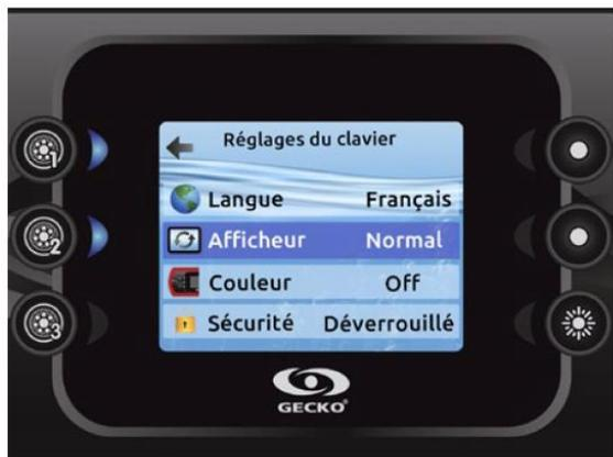
Vous pouvez verrouiller le clavier en sélectionnant un des 3 niveaux de sécurité: Déverrouillé, Partiel ou Complet. Le niveau Partiel verrouille le réglage de consigne et plusieurs options dans le menu des réglages. Le niveau Complet verrouille toutes les fonctions du clavier. Pour déverrouiller le clavier (Partiel ou Complet), appuyer sur la touche du haut à droite pour 5 secondes.
